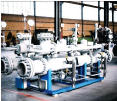
اجكتور دستگاهی برای مکش، انتقال، تراکم و یا اختلاط گازها، بخارات، مایعات و حتی ذرات جامد می‌باشد و به نوعی نقش کمپرسور را بازی می‌کند که در آن انرژی پتانسیل یک سیال محرك (گاز یا مایع) فشار بالا با گذشتن از یک نازل، به انرژی جنبشی تبدیل شده و با کاهش فشار استاتیک می‌تواند ماده ثانویه‌ای را مکش کند. در نتیجه سیال محرك و ماده ثانویه در دیفیوزر با یکدیگر مخلوط شده و متراکم می‌گردند. در اقع اجكتور یک پمپ خلاء است بدون اینکه دارای پیستون، سوپاپ، روتور یا هرجز متجرک دیگری باشد.
