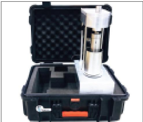
دستگاه ویسکومتر برای اندازه گیری میزان ویسکوزیته سیال و سیمان حفاری بروی دکل های حفاری استفاده می شود. این دستگاه همچنین در آزمایشگاه های مرجع و تولید کننده افزایه های شیمیایی مورد استفاده در سیال حفاری جهت کنترل کیفی مواد ساخته شده استفاده می شود.
