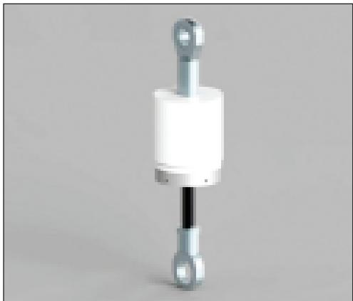
این نوع نگهدارنده ترجیحاً در خطوط لوله دارای سیستم عامل حرارتی مورد استفاده قرار می‌گیرد و در تکانه‌های حرکتی شدید (بطور مثال هنگام وقوع زمین لرزه) به صورت صلب عمل کرده و انرژی حاصله را به یک باره جذب و بدون اینکه آسیبی به سیستم برسد و بدون خطر آن را منتقل می‌کند. در غیر این شرایط (تکانه‌های حرکتی شدید) به آرامی با حرکات لوله همراهی می‌کند.
