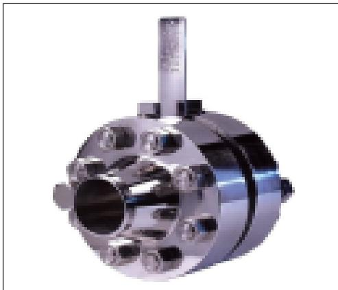
اریفیس جزء قدیمی ترین روش‌های اندازه‌گیری دبی است. در این روش، جریان سیال از مجرایی که از سطح مقطع جریان اصلی کوچکتر است، عبور داده می‌شود. اختلاف فشار ایجاد شده، توسط یک وسیله اندازه‌گیری اختلاف فشار، اندازه‌گیری شده و دبی سیال با استفاده از روابط حاکم به دست می‌آید. از سازندگان مطرح این نوع ابزار دقیق می‌توان به شرکت‌های Rosemount و E&H، Dwyer، Siemens، ABB اشاره کرد.
