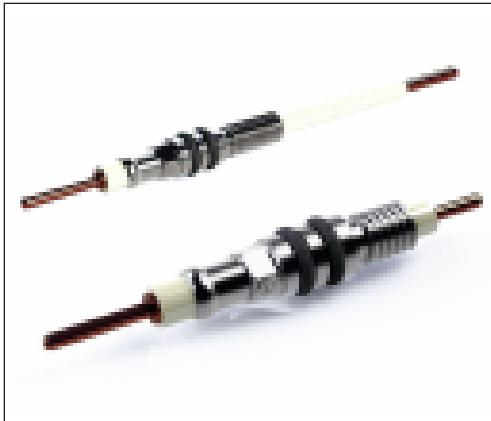
کانکتورها در سیستم ابزارهای نمودارگیری به نام Cable Head یا Feed Thru یا Candle Rod یا شناخته می‌شوند یک پین از طریق ماده‌ای عایق در مرکز غلاف قرار گرفته است و ماده عایق نیز اندکی از دوطرف غلاف به بیرون گسترش یافته است. روی بدنه غلاف، بسته به کاربرد و نوع ابزار، یک آچار خور، یک یا دو اورینگ و یک رزو به منظور بستن کانکتور به بدنه تعییه می‌شود.
