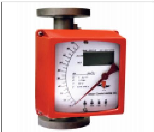
روتامتر مدل ACA+1 با بدنه فلزی می‌تواند برای اندازه‌گیری دیگازها و مایعات مختلف به کار می‌رود. جنس کلیه اتصالات و قطعات در تماس با سیال از SS است. این ویژگی علاوه بر امکان تحمل فشار و دمای بالا باعث می‌شود که از آن بتوان برای اندازه‌گیری دبی سیالات خورنده نیز استفاده کرد.
